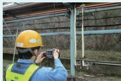
撮影:蒸気配管、継手の断熱効果を調べるために、赤外線カメラで撮影をする作業員
